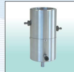
連続的な処理を行う場合に使用します。試料はチップの直下を通過し照射されます。又、ホルダーはジャケット構造を採用しています。
