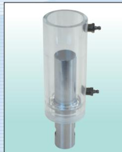
コンバーターを逆さにして取り付けます。超音波はカップ部の媒体を通し間接的に照射します。従って、汚染物質や放射性物質、極端にコンタミネーションを嫌う製品、厳密な温度管理が必要な試料などに使用します。
