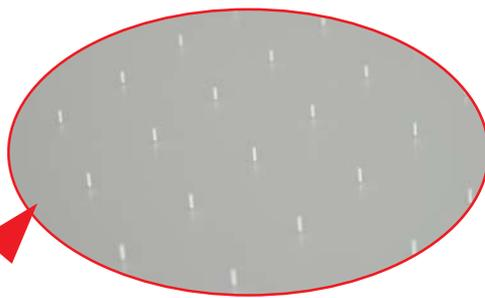
ガラスに $\phi 0.5 \sim \phi 1$ までの微細な穴を複数個開ける事で吸着力の強弱を決めています。
