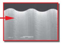
SEM で確認すると溝の先端と 深部は R 構造をしています。
