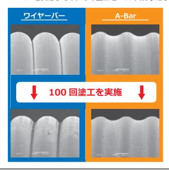
左の写真の通りワイヤーバーの溝には同じ洗浄をしても インキが溝に残ってしまっています。この状態では目詰 まりしたインキの影響でスポット量が変わってしまい、 膜厚に影響が出てしまいます。
